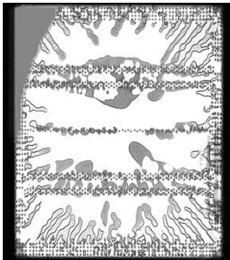
図3. 共晶はんだバンプで組み立てられた場合、245°C のプリコンディショニングリフロー・ピーク温度でアンダーフィルの剥離とはんだの広がり/染みが発生
