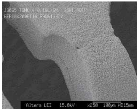
図9. PQFP デバイスの無光沢Sn仕上げリードの高倍率画像
