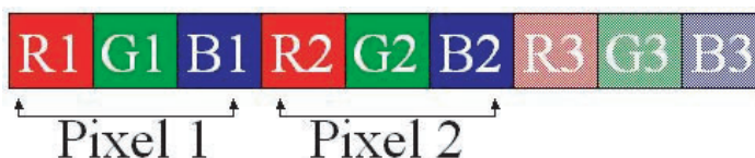
図 4. 標準 LCD 上のサブピクセルの構成
