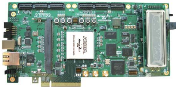
PCIe、ギガビット・イーサネット、CPRI、OBSAI、SDI、XAUI、SATA、GPON など主流の 3G プロトコルの検証を容易に実現
